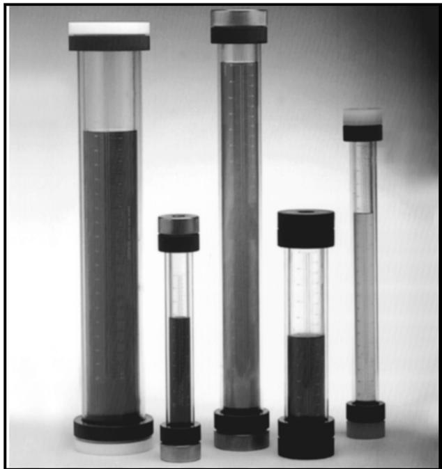
Las Columnas de Calibración de Vidrio de Borosilicato Griffco están diseñadas para mejorar el rendimiento de sistemas de alimentación de químicos, ya que proveen verificación del caudal de la bomba de alimentación de químicos. Están construidas en vidrio de borosilicato. Tapas en 7 materiales distintos (PVC, CPVC, PP, PTFE, PVDF, 316 SS, A20). Estas columnas pueden usarse con la mayoría de químicos y vienen en 13 tamaños; 30, 100, 200, 500, 1000, 2000, 3000, 4000, 5000, 7000mL, 10, 15 y 20 L.
