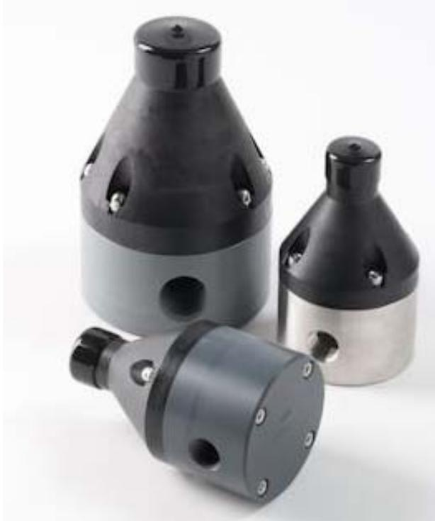
Las válvulas de alivio de presión de diafragma de alto flujo **Griffco** están diseñadas para proteger a los sistemas de transferencia de químicos contra daños producidos por presiones excesivamente altas, causadas por equipos defectuosos o bloqueos en la tubería de alimentación de químicos. Sus orificios grandes facilitan altos flujos y altas viscosidades. Los materiales de las partes húmedas incluyen: **PVC, CPVC, PP, PVDF, PTFE, 316SS, A20 y Hast.**
